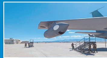
KC-135翼端掛載新型通訊英艦，可整合多種資料鏈，協助戰區友軍即時更新戰情。（取自第151聯隊網站）
