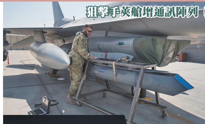
▲「狙擊手NTP」可望大幅提升第4代戰機的網路化作戰能力。圖為美軍F-16戰機掛載「狙擊手ATP」英鎗。（取自VIDDS網站）
