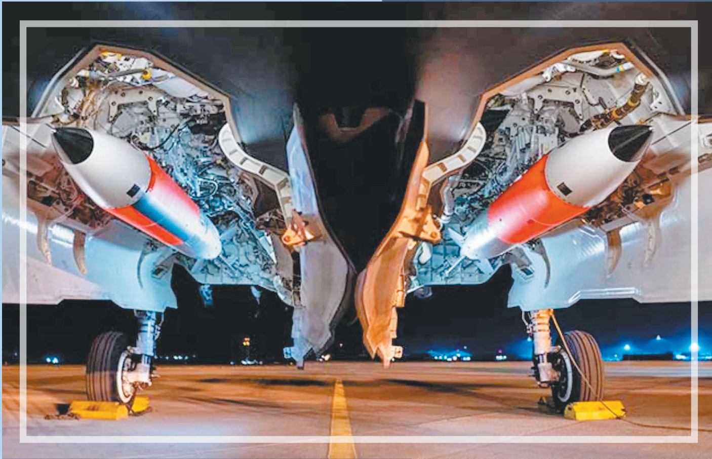
↑ 美軍 F-35A 機腹彈艙掛載延壽型 B61-12，進行一系列測試，驗證美國關鍵核嚇阻能力。（取自 SNL 網站）
