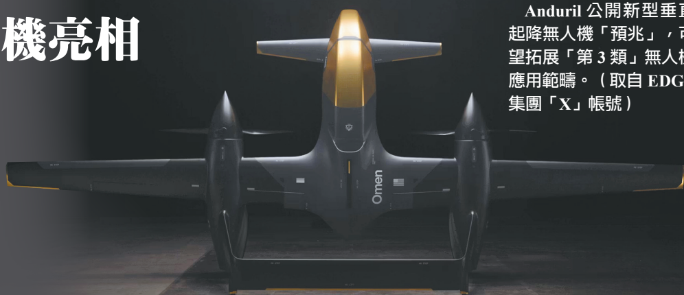
「預兆」採用先進的尾座式起降設計，具備可靠的垂直起降彈性。（取自 Anduril「X」帳號）
