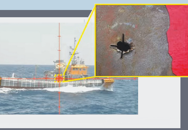
↑照片顯示，電磁砲砲彈具備平直彈道特性，並在靶船上留下十字形彈痕。（取自 ATLA）
