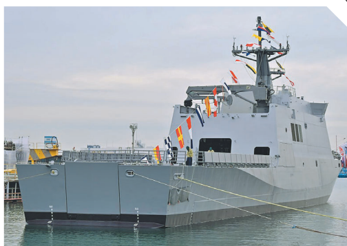
↑ 新型 OPV 艦體後部設有機庫與多功能甲板，未來可部署「V-BAT」垂直起降 (VTOL) 無人機。（取自開源情報 OSINT「X」帳號）
