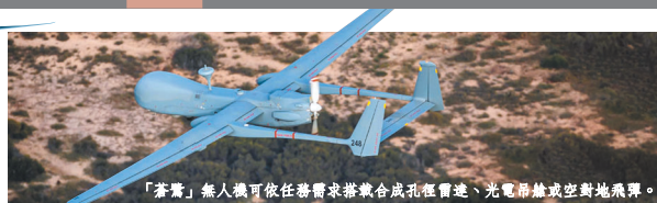
「蒼鷹」無人機可依任務需求搭載合成孔徑雷達、光電吊艙或空對地飛彈。
