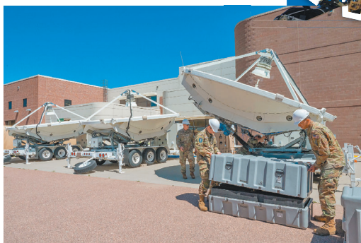
▲RMT是一款可遠端操控的小型低成本衛星干擾裝置。 (取自美國太空軍網站)
