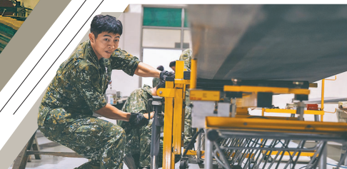
◆複材配造所官兵運用平衡儀葉片承載車在葉片中心將其撐起，並移至靜態平衡儀上方進行檢測。
