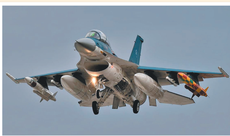
日本空自F-2戰機掛載ASM-3反艦飛彈，最大射程為150至200公里，並配備彈體外側雙進氣通道、整合式衝壓發動機、慣性／全球定位系統（GPS）導引、末端主動／被動雷達導引等。（取自NAVALNEWS網站）
