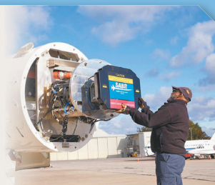
諾格公司的 IVEWS 電戰套件經過大量測試後，已與 AN/APG-83 雷達正式完成整合。圖為美軍 F-16 戰機。（取自 DVIDS 網站）
